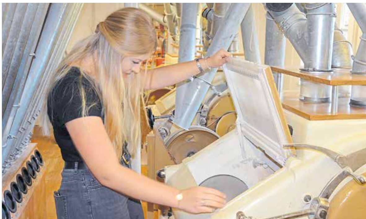
Läuft alles wie es soll? Luisa Winkler kontrolliert den Prozess an einem der Walzenstühle in der Winklermühle.
